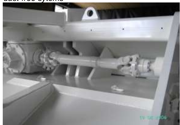
Kraftübertragung vom Mittelgetriebe zu den seitlichen Riemenantrieben über Kardanwellen
